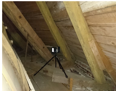
Abb. 3.1.6-2: Aufmaß des gesamten Bauwerks mit 3D-Laserscanning.
