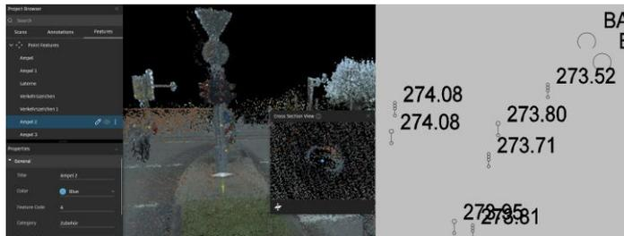
Grundlegende Funktionen, wie das Abgreifen von Maßen, automatische Erkennung von Rohrdurchmessern, Erstellung von Anmerkung oder Hinzufügen von Bildern wird ebenfalls unterstützt. Des Weiteren kann die Punktwolke analysiert werden.
