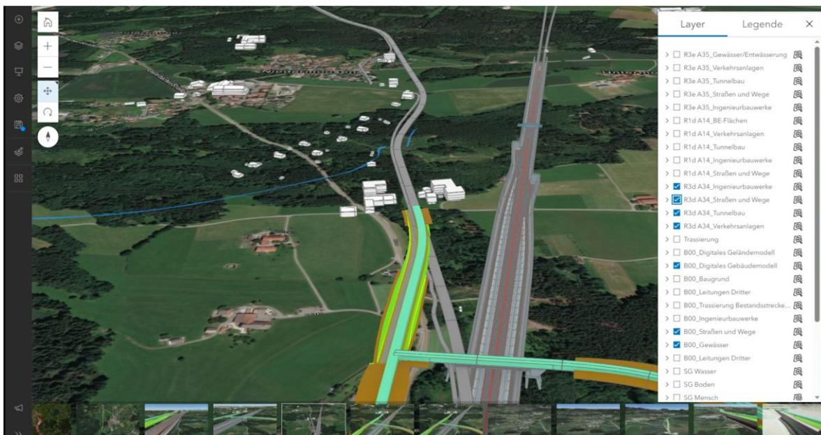
Abb. 3.2.7-1: BIM-GIS-Integration - Gesamtmodell Brenner Nordzulauf in ArcGIS online
