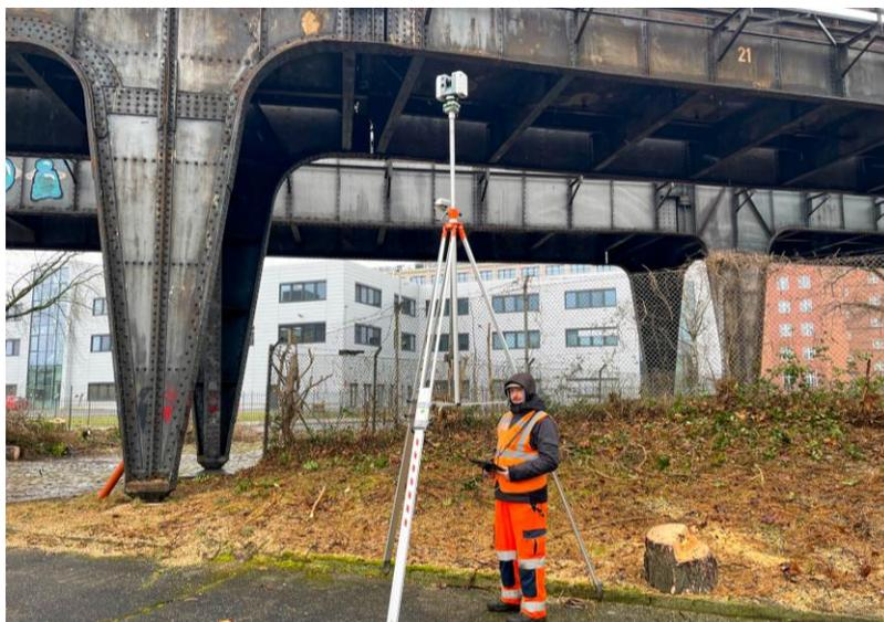
Abb. 3.1.10-1: 3D-Laserscan der Stahlviadukt Stützen aus verschiedenen Perspektiven.
