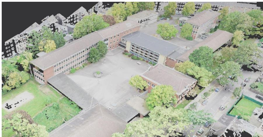
Abb. 3.1.21-1: Punktwolke des Gebäudekomplexes inkl. Randbebauung aus der Drohnenaufnahme, Quelle: KKI
