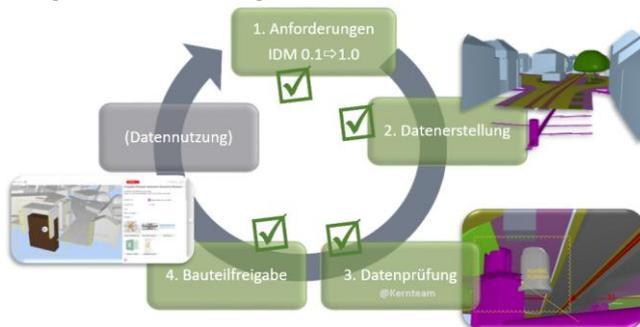
Abb. 3.2.6-3: Schematischer Ablauf vom BIM-Pilotprojekt Neuweilerplatz. Von Schritt 1 bis Schritt 4: Die IDMs werden aufgestellt (IDM 0.1), Bauteile daraus generiert (2.) und geprüft (3.), dann Bauteile und Anforderungen geprüft, ob beide zur Zielerreichung des Anwendungsfalls beitragen (4.) und die Anforderungen für das alltägliche Geschäft angepasst (IDM 1.0).
