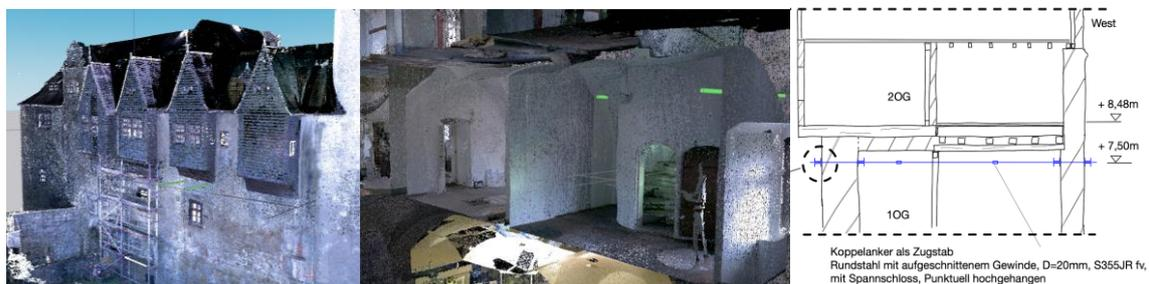
Abb. 3.1.23-2: Visuelle Kollisionsprüfung CAD-Modell mit Punktwolke. Links: Ostansicht mit Bohransatzpunkten. Mitte: Innenansicht der antreffenden Ankerstangen. Rechts: Durchgezeichnete formgerechte Schnittdarstellung mit Prinzipdetail.
