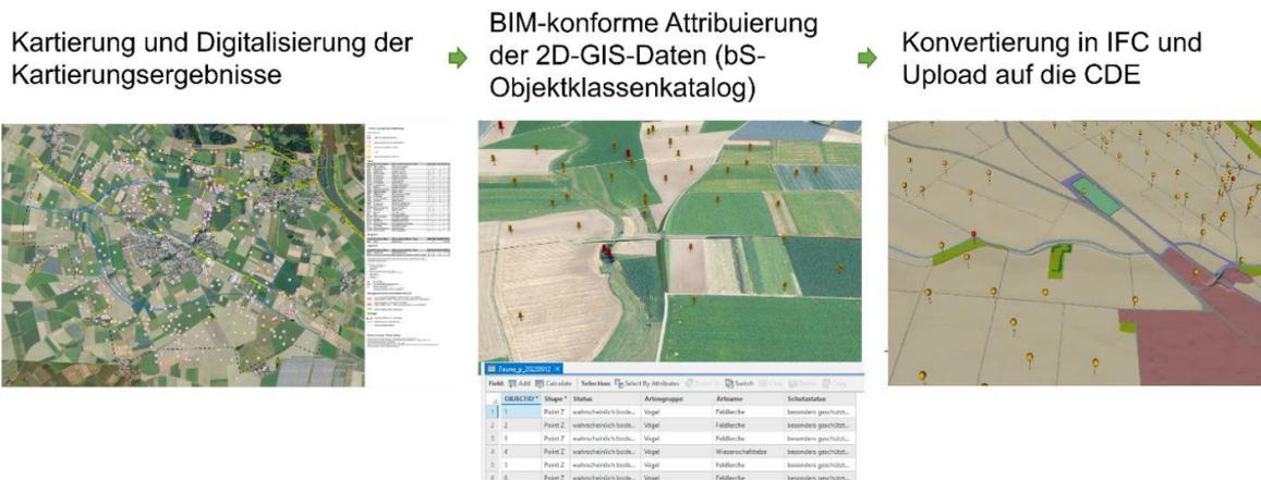
Abbildung 3.2.3-3: Umsetzung der 2D-Firma-Fundpunkte ins 3D-Modell
