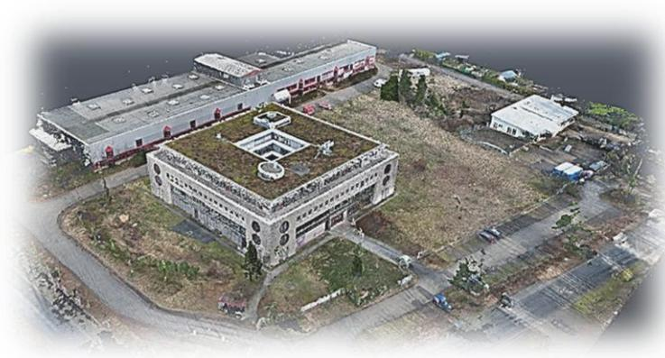
Abb. 3.1.17-3: Akademiegebäude aus terrestrischer und UAS- Photogrammetrie
