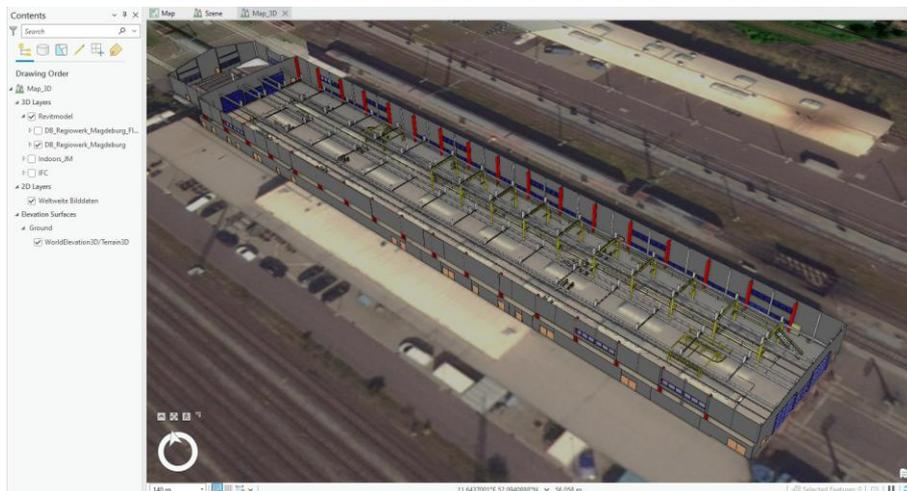
Abbildung 3.2.8-1: 3D-Bestandsmodell in ArcGIS Pro mit Sicht ins Innere der Halle
