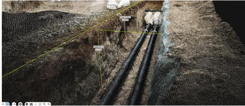
Abb. 3.1.19-4: Ermittlung von Grabenbreite, -tiefe und -länge für die Abrechnung
