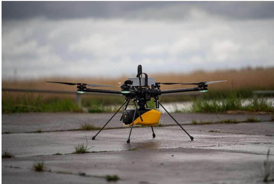
Abbildung 2.3.2 - 1: Die Hexadrone Tundra 2 mit dem YellowScan Navigator
