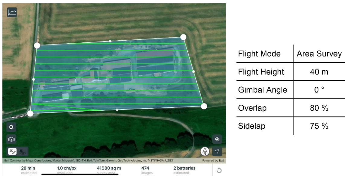
Abbildung 2.2.3 - 2: Flugplanung der Nadir-Aufnahmen des Betriebsgeländes
