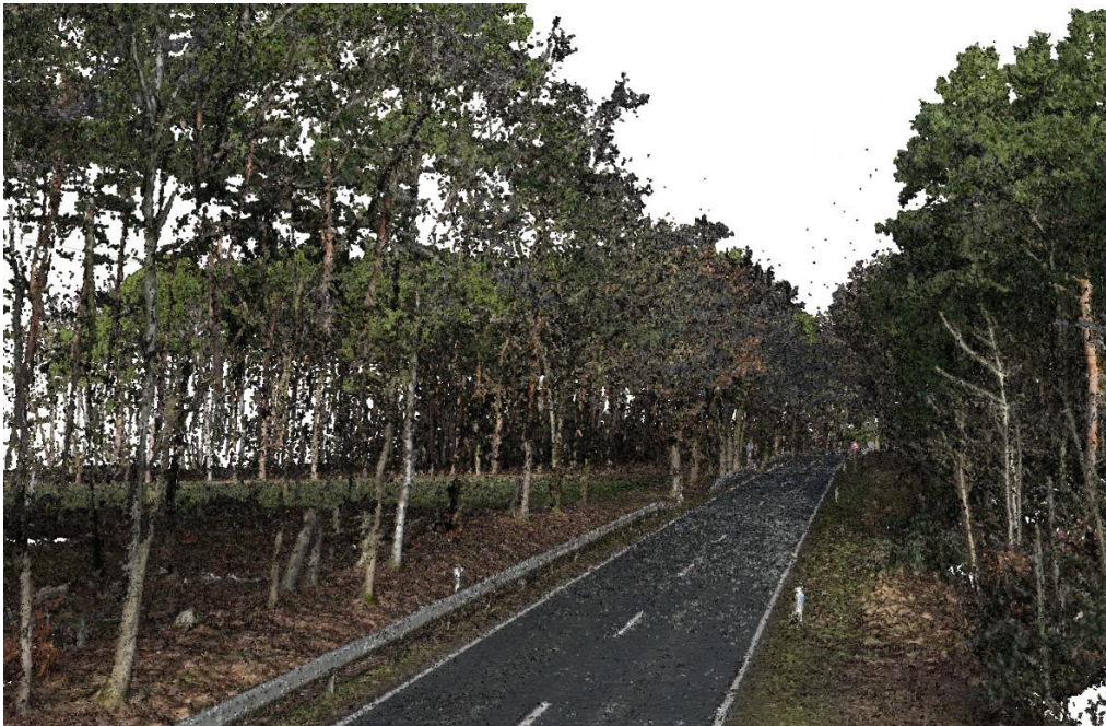
Abbildung 2.1.2 - 1: Beispiel einer rein photogrammetrischen Punktwolke aus per UAS erfassten Bildern
