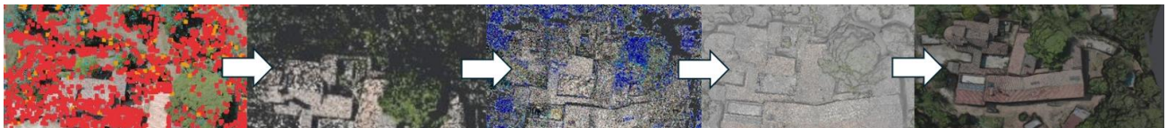
Abbildung 2.6.1 - 4: Extrahierte Features, Structure from Motion Punktwolke, Tiefeninformationen (blau), Mesh, Texturiertes Mesh
