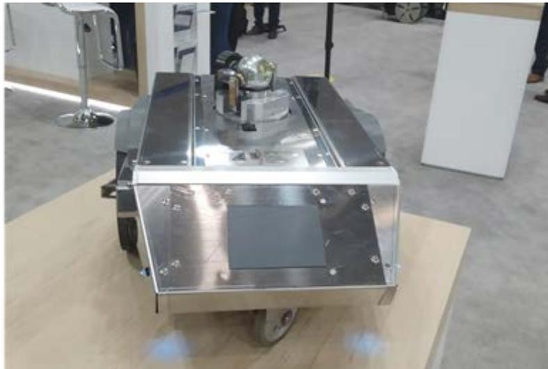
*Abbildung 4: Quasi-autonomer Vermessungsroboter*
