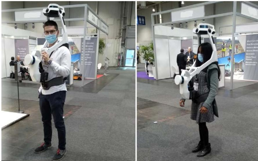
*Abbildung 2: Mitglieder des Trendanalyse-Teams mit einem schultergetragenen mobilen Laserscanner samt Kameras*
