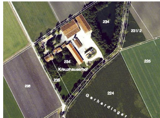
Abbildung 17: Digitales Orthophoto überlagert mit Daten der Digitalen Flurkarte
