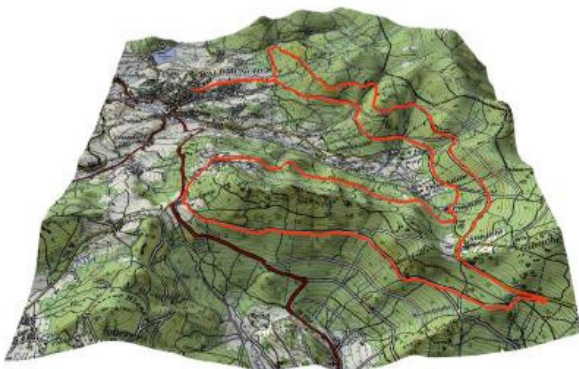
Abbildung 27: Überlagerung thematischer Informationen im GIS für touristische Zwecke: Darstellung eines Höhenweges durch Überlagerung der Wegeinformation mit der Digitalen Topographischen Karte auf perspektivischer Darstellung des Digitalen Geländemodells
