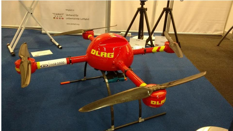
*Rettungsdrohne, an deren Unterseite zwei automatisch abwerfbare Rettungsbojen befestigt werden können*
