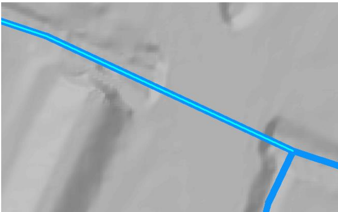
Abbildung 151: DGM deutet auf Untertunnelung hin
