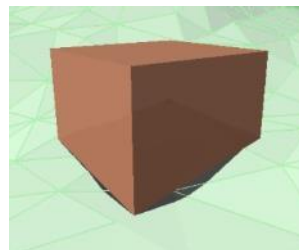
d) Grundrissknoten mit Gelände verschneiden
