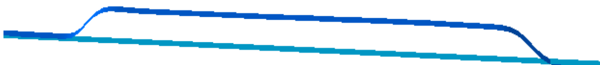
Abbildung 101: Linie folgt bei Interpolation an Stützpunkten dem DGM
