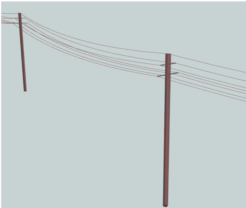
Abbildung 166: Erzeugte Mast- und Seilgeometrie (Erdseil und Leiterseile)
