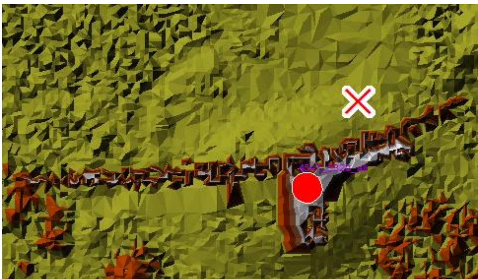
Abbildung 185: Orthogonale Ansicht (LAS als TIN): Positionen des Windrades aus dem DLM als rotes Kreuz, Position aus Datensatz der Hausumringe ( Gebaeude_BY.shp ): Roter Kreis
