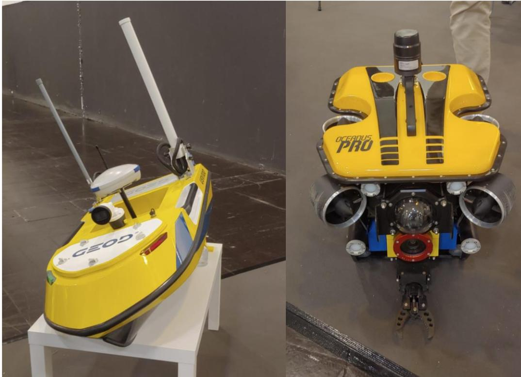
Abbildung 2: Messboot und Tauchroboter für bathymetrische Aufnahmen
