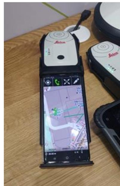
Abbildung 2 – Mobile GIS-Hardware bestehend aus RTK-GNSS-Antenne, Smartphone und Halterung
