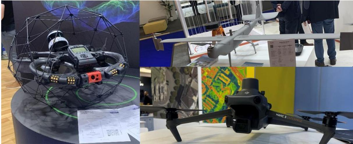
*Abbildung 3: Kollektion verschiedener Systeme (links: Drohne für Indoor-Kartierung; rechts oben: Drohne mit festen Flügeln, langer Flugzeit bis zu 90 Minuten und hoher Fluggeschwindigkeit bis zu 17 m/s; rechts unten: kleine und kompakte Drohne).*
