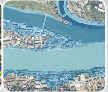
Digitales Geländemodell, auch in Kombination mit dem 3D-Gebäudemodell LoD1 (Flachdach) oder LoD2 (standardisierte Dachformen) als Grundlage für eigene Hochwassersimulationen
