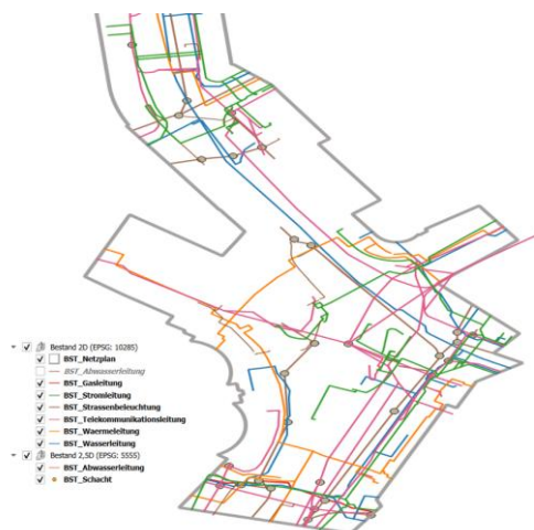
Abb. 3.2.9-2: Ausschnitt der Layerstruktur in QGIS nach Datenimport und -bearbeitung.
