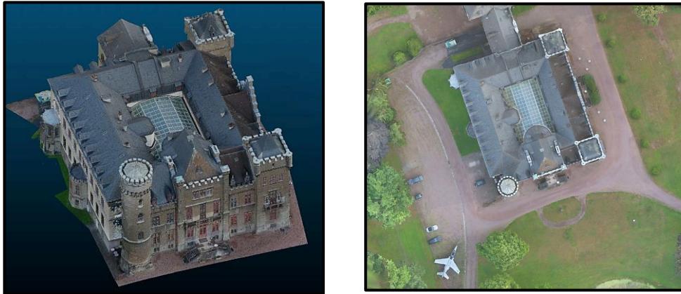
Abb. 3.1.6-1: Punktwolke (links) und DOP (rechts) aus UAS- Daten
