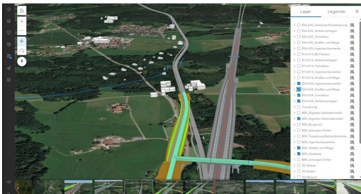
Abb. 3.2.6-1: BIM-GIS-Integration - Gesamtmodell Brenner Nordzulauf in ArcGIS online
