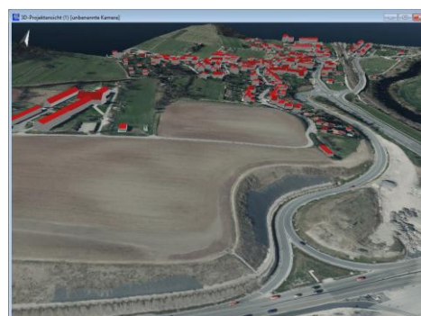
Abb. 3.2.1-9: Kombination aus DGM mit Luftbild auf der Oberfläche und 3D-Gebäuden in der 3D-Projektansicht.
