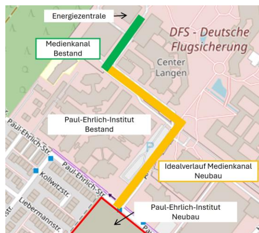
Abb. 3.1.33-1: Übersicht des bestehenden (grün) und neu geplanten (orange) Medienkanals (Quelle der Hintergrundkarte: OpenStreetMap)
