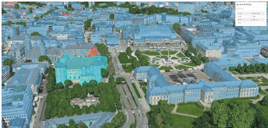
Abb. 3.2.12-3: 3D-Mesh und GIS-Layer mit Gebäudeinformationen (blau eingefärbt)
