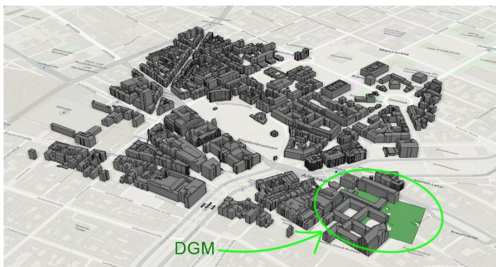
Abb. 3.2.11-1: Ergebnis eines Durchlaufs – 3D-Stadtmodell als IFC (FME-erzeugt), Geländemodell (Original) und Hintergrundkarte (ArcGIS online), gemeinsam als Umgebungsmodell in ArcGIS Pro
