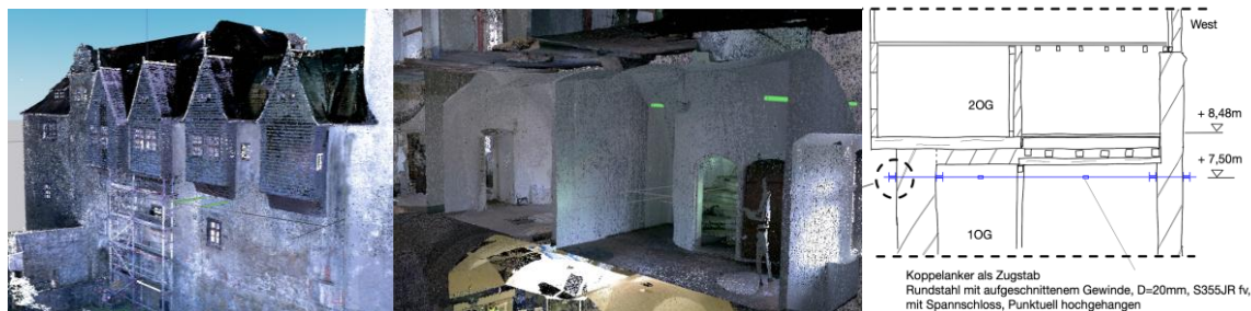
Abb. 3.1.12-2: Visuelle Kollisionsprüfung CAD-Modell mit Punktwolke. Links: Ostansicht mit Bohransatzpunkten. Mitte: Innenansicht der antreffenden Ankerstangen. Rechts: Durchgezeichnete formgerechte Schnittdarstellung mit Prinzipdetail.
