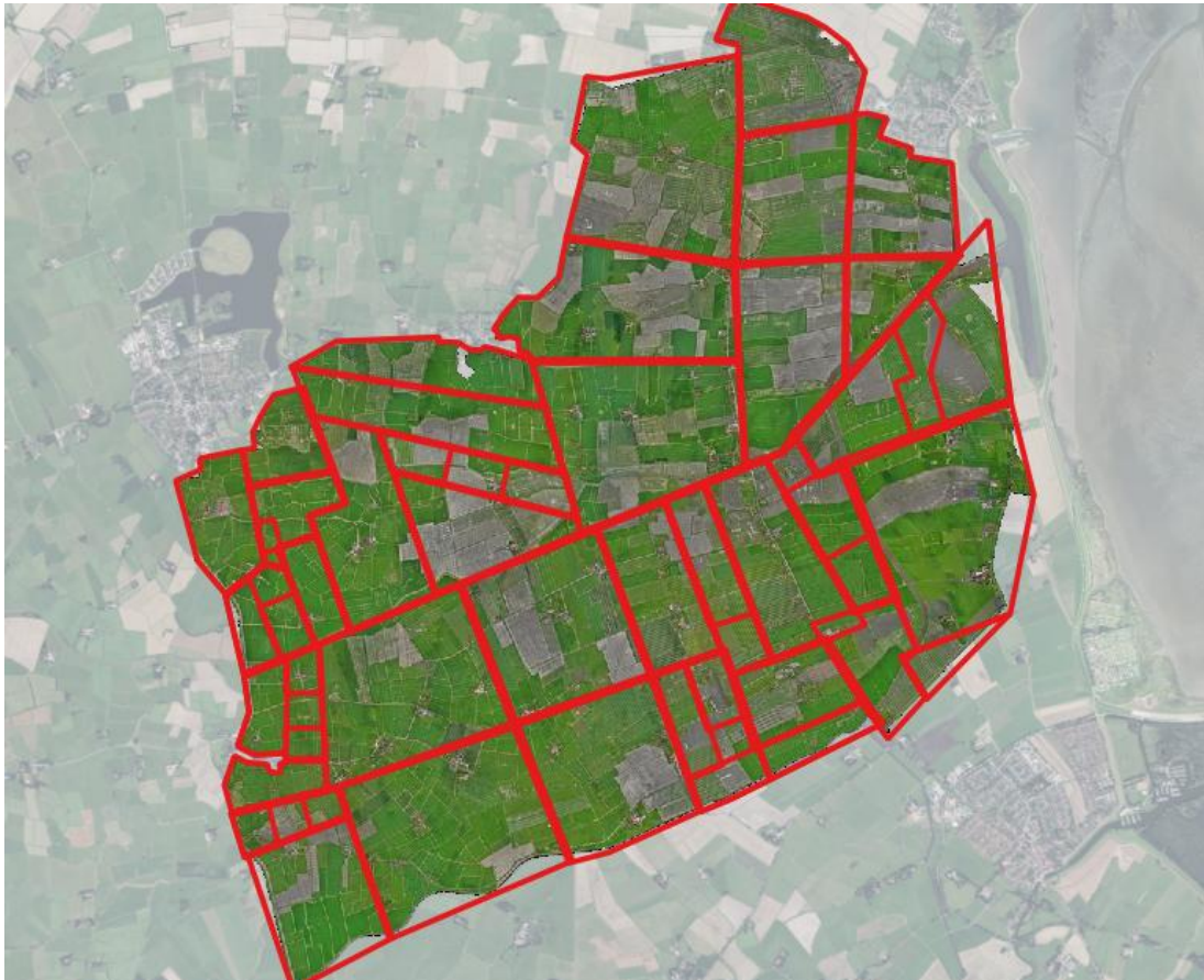
Abbildung 2.1.1 - 1: Beispiel eines per UAS erfassten TrueDOP eines Flurbereinigungsverfahrens (34 km 2 ). Hintergrund: transparentes DOP20, UAS-Flugplanungssegmente in Rot (bspw. wegen rechtlicher Vorgaben oder höherer Flughöhen über Windkraftanlagen)
