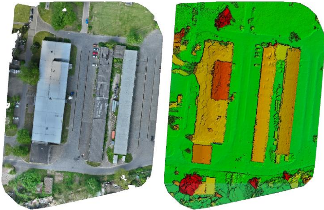
Abbildung 1.3.2.4 - 3: Orthomosaik des Testgebiets und das entsprechende DOM
